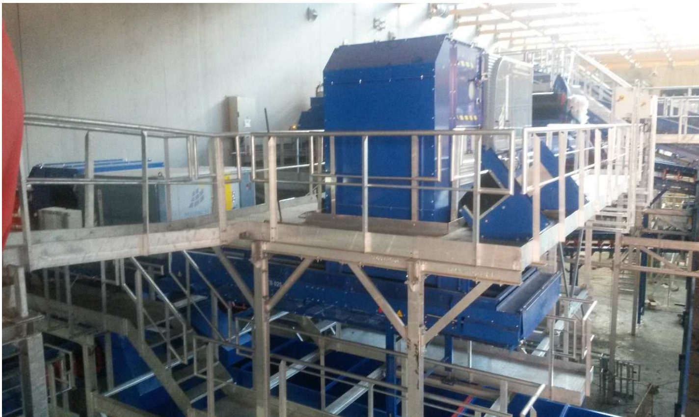
Intérieur du bâtiment de tri primaire – Tri optique (extraction des plastiques) (photo d'août 2015)
