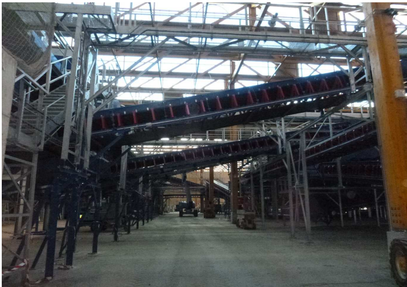
Intérieur du bâtiment de tri primaire – Convoyeurs reliant les trommels 400mm aux trommels 200mm (photo de septembre 2015)
